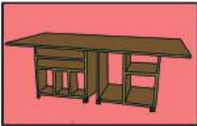
Este modelo de estación de trabajo para costura, consta de dos estantes con ruedas que sirven de soporte a una gran tabla superior recubierta con melamina para facilitar el deslizamiento de las telas. Los compartimientos se diseñaron para apilar cajas, 3 máquinas de coser y 2 entrepaños para colocar los materiales de papelería y patrones de costura.
